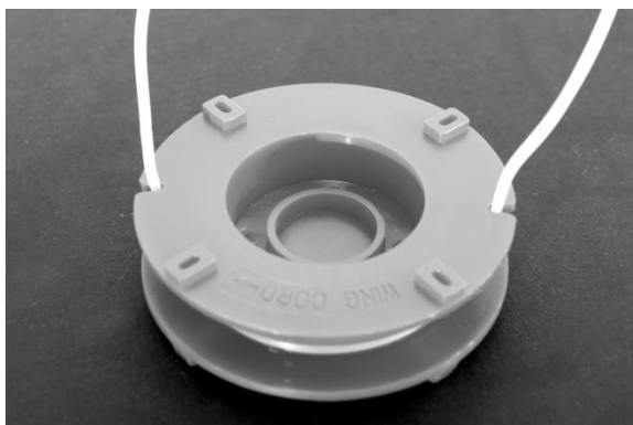
Keď sa hlava otáča, navíňte nylon do otvoru v opačnom smere. Nylonové laná musia byť rovnomerne v medzere a nesmú sa vzájomne križovať.
