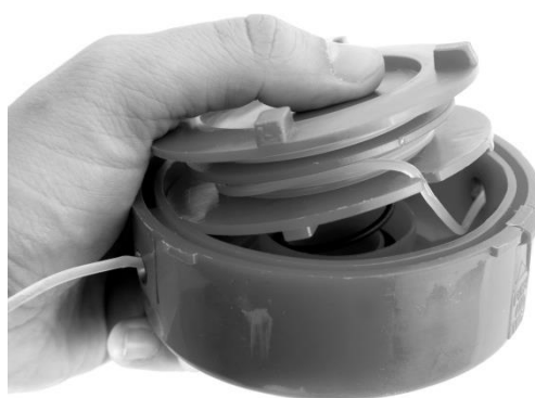
Vložte valec do spodnej časti hlavy. Dávajte pozor, aby sa línia dotýkala bubna navijaku.
